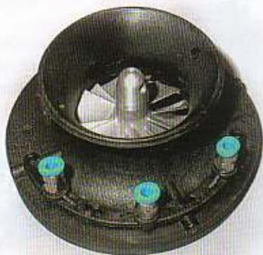
Kleines Detail: Auch die Aufnahme für die Gas-Kerosin-Anschlüsse ist ein Spritzgussteil
